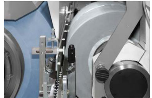
**+ Presión de rectificado constante:** La matriz de aglomerante elástica compensa las irregularidades de la pieza de trabajo y genera así una presión de rectificado uniforme en toda la longitud de la muela abrasiva.
