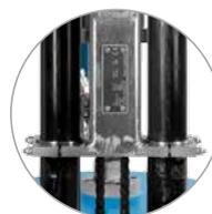
Los brazos de reducción permiten perforaciones con diámetro de hasta 1000 mm
