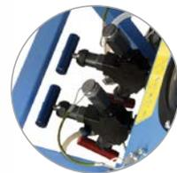
Dos salidas regulables por separado para trabajos de presión controlados
