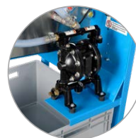
Bomba de vacío
