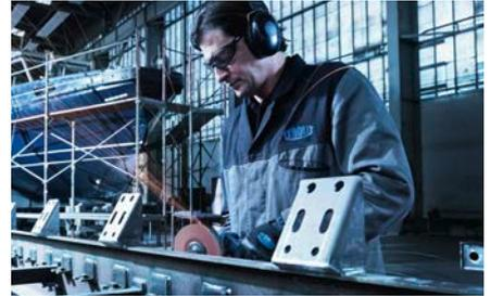
**+ Arranque de material más rápido gracias a estructura de grano única:** Gracias a la nueva estructura del grano cerámico utilizado, así como al aglomerante mejorado de los granos entre sí, los discos de fibra CERABOND X logran un arranque de material extraordinario.
