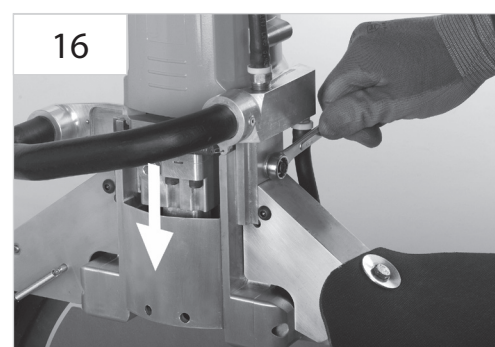
16 Gehäuse auf Tischkante drücken und gedrückt halten. Schutz mit Spritzlappen festschrauben. Werkzeug: Schraubenschlüssel ½"
