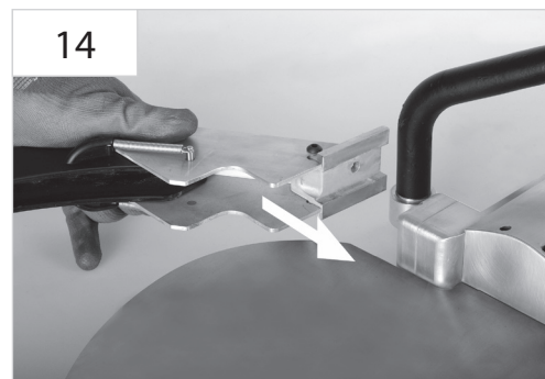
14 Bügelschutz leicht von Hand anschrauben.
