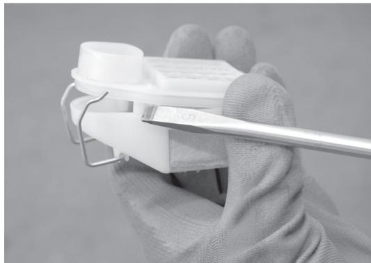
6. Séparer les parties supérieure et inférieure du filtre à air comme indiqué sur l'illustration. Vider le filtre en le tapotant ou en le soufflant à l'air comprimé, avec précaution.
