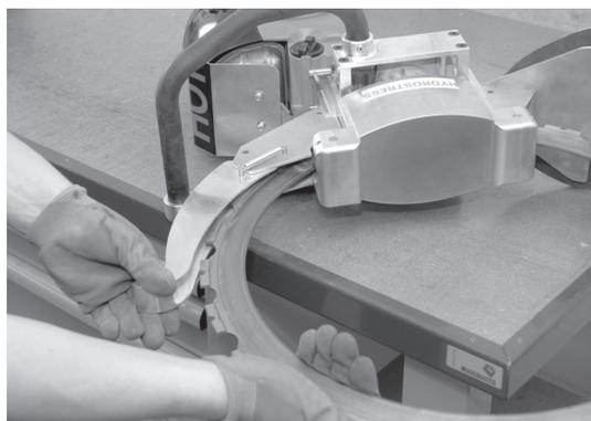
5. Positionner le pare-lame sur la lame.
