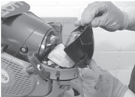
8. Remonter le filtre et le capot du filtre.
