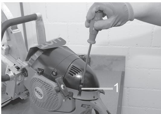
1. À l'aide d'un tournevis, détacher les clips (1) du capot du filtre.
