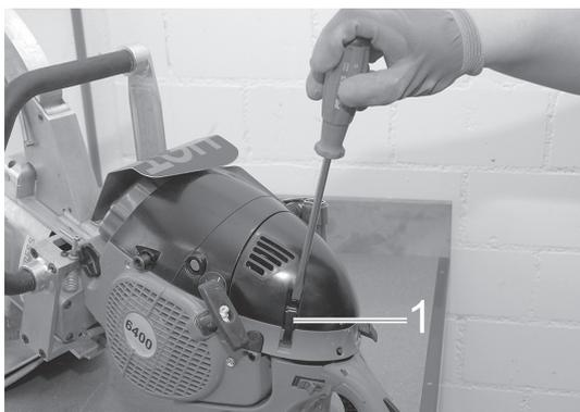
1. Desenganchar los clips de cierre (1) de la tapa del filtro con el destornillador.
