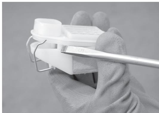
6. Separar la parte superior e inferior del filtro de aire como se muestra en la imagen. Golpear con cuidado o soplar con precaución con aire comprimido.
