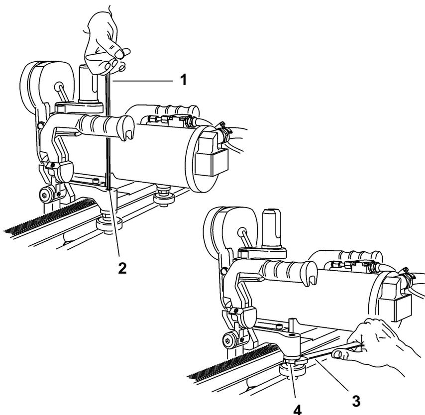
Fig. 4-2 Regolazione dei rulli di guida
