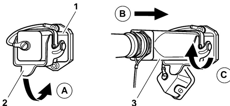
Connettore del motore di avanzamento
