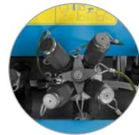
Accesorios: cabezal distribuidor para 8 herramientas de prensado
